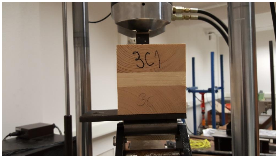
Figur 4.6: Stålplatta mellan balk och rullager. Bilden visar fallet för h_g = 100 mm.
