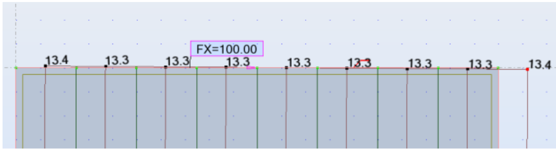
Figur 5.21 Ytterligare förstoring av Figur 5.19, av toppen av väggbalken. Beräknad utböjning åt höger är även utskrivet vid varje förflyttad nod.
