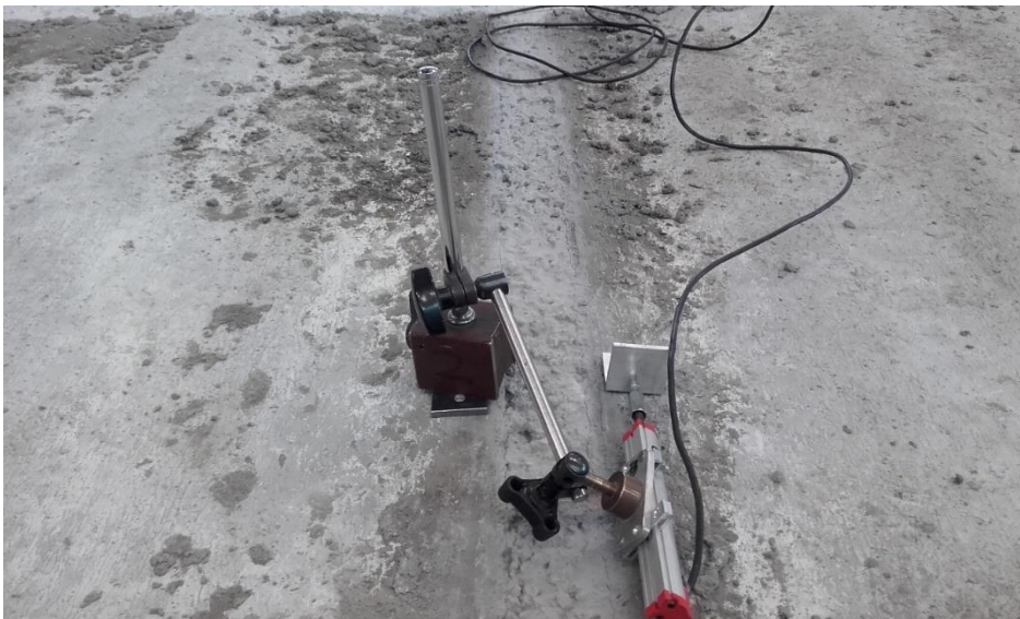
Figur 5.13: Deformationsmätare över fog.
