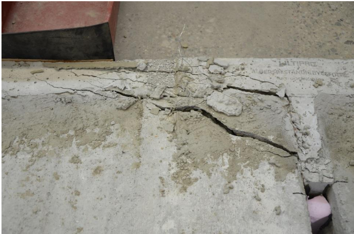
Figur 5.31: Sprickbildning i fog 1 dragen sida, upplag till vänster i figuren.
