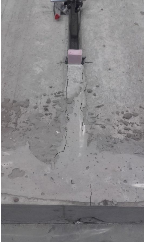
Figur 5.21: Sprickbildning över fog 3 dragen sida.
