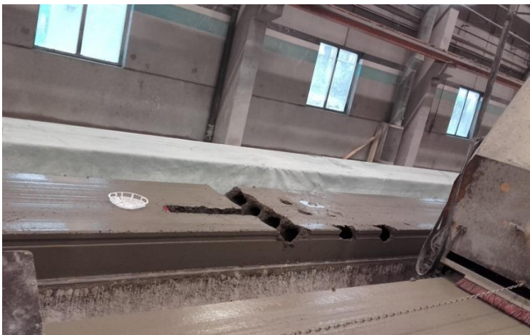
Figur 2.4: Borstning, hålltagning och härdning.
