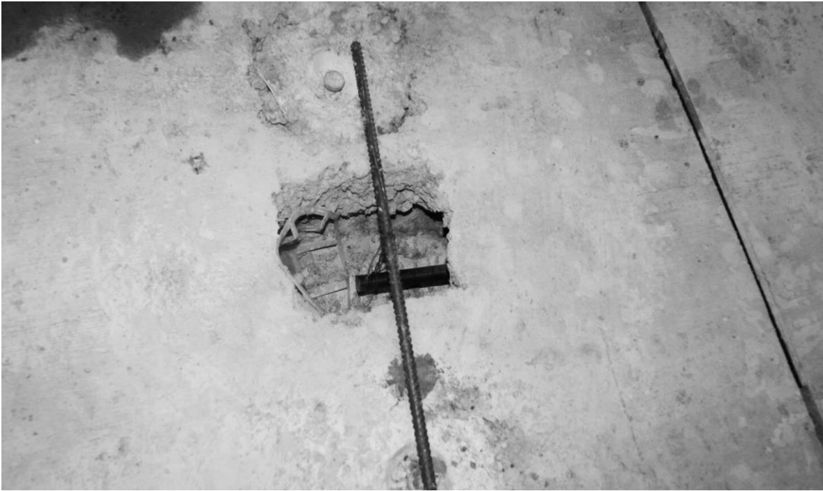
Figur 5.5: Provtyp C med titthål.
