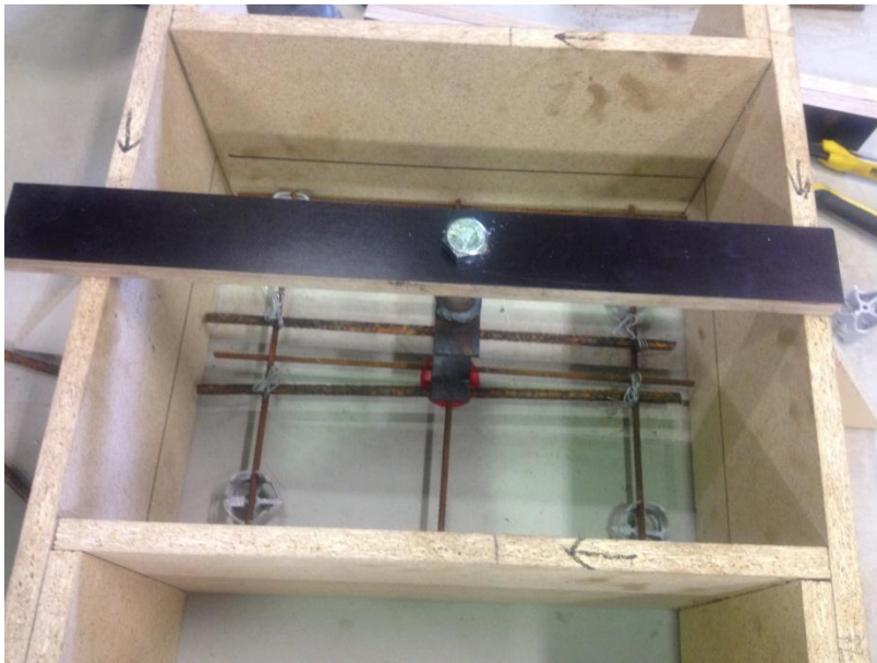
Figur 42. Placering av infästning med plywood som limmas mot form.
