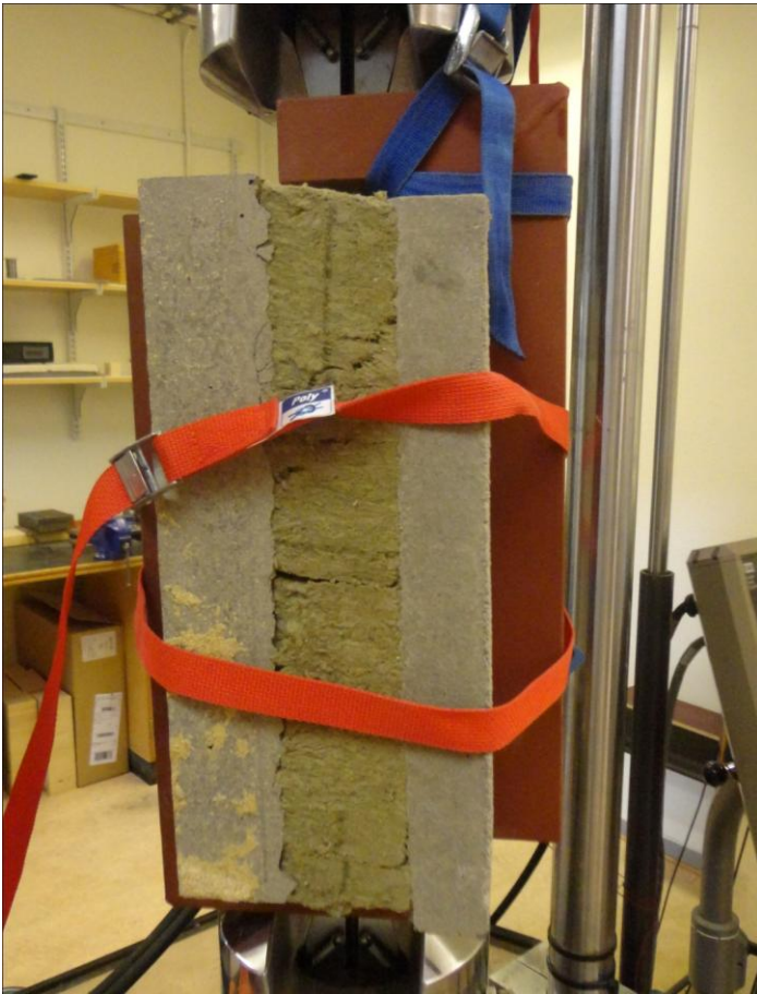
Figur 59. Brott i skjuvad provkropp.
