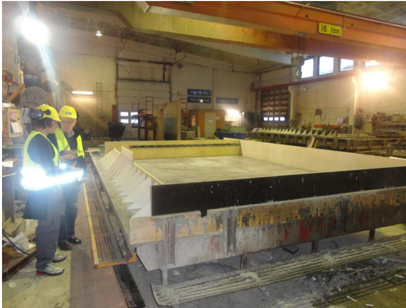
Figur 8. Formen placerad på gjutbädden.
