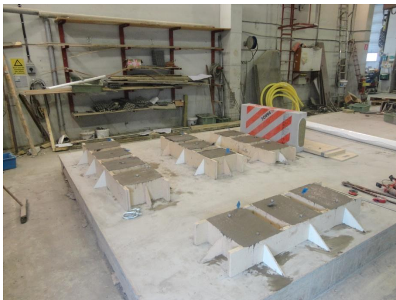
Figur 44. Provkropparnas yta jämnas till.
