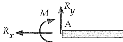
Reaktionskraft R med komponenter R_x och R_y och inspänningsmoment M
