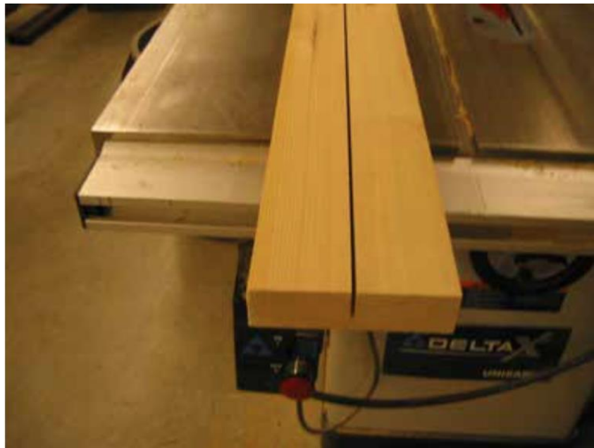
Figur 10 Längsgående sågade skårar för att reducera spänningar, foto taget av FPIinnovations [6]
