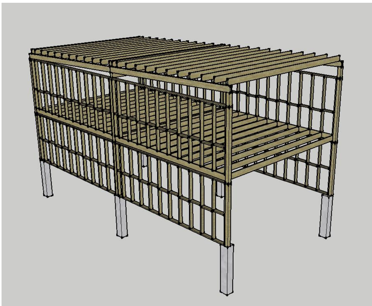
Figur 6.2 Påbyggnadens bärsystem med träregelstomme för en lägenhetsenhet. De underliggande betongpelarna representerar bärlinjerna för den befintliga byggnaden. Kortsidor är inte utritade för att ge en tydligare vy av stommen.
