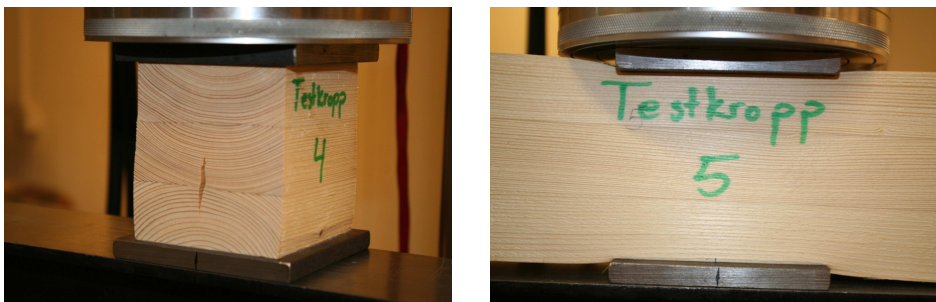
Figur 5.3: Ca 10 % töjning för träkloss och träbalk.
