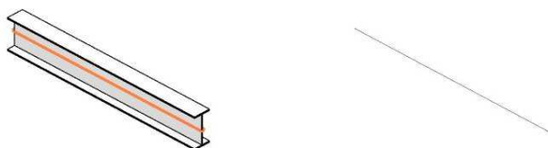
Figur 15: Till vänster: Fysisk representation av IPE-balk i Revit. Den tjocka linjen anger var balkens analytiska representation, en linje, är belägen. Linjen ligger i tvärsnittets tyngdpunkt. Till höger: Den analytiska representationen i Robot - ett 3D-balkelement.
