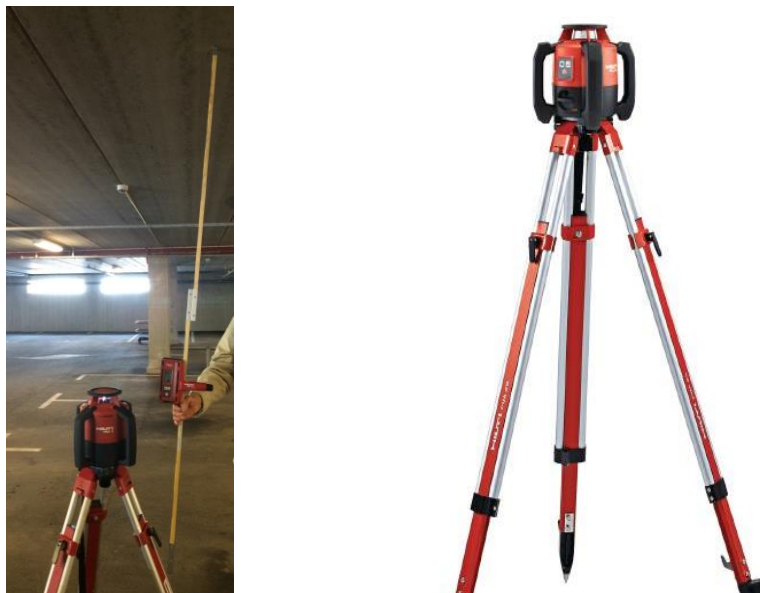
Figur 6.2. Rotationslaser, mottagare och mätpinne.
