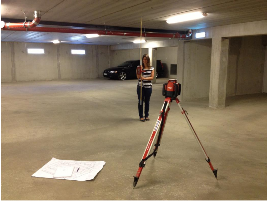
Figur 6.4. Mätmetod vid takhöjd lägre än 3 meter.
