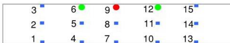
Figur 46 - Excitationsschema – 9 är en tri-axiell accelerometer samt excitationpunkt, 6 & 12 enaxiella accelerometrar samt excitationpunkter blåa punkter är excitationpunkter.
