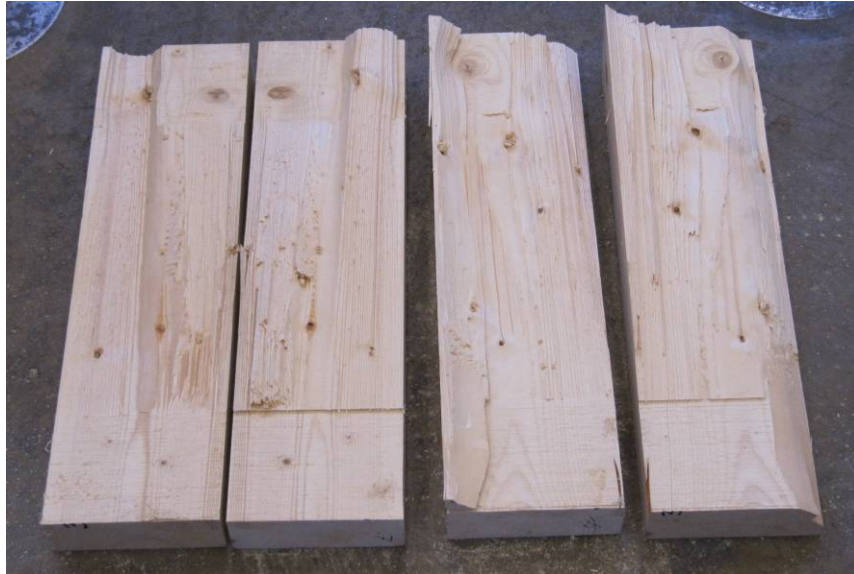
Proserie 3: rektangulärt tvärsnitt, b=165 mm
