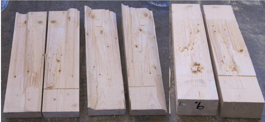
Proserie 9: rektangulärt stående tvärsnitt, b=115 mm
