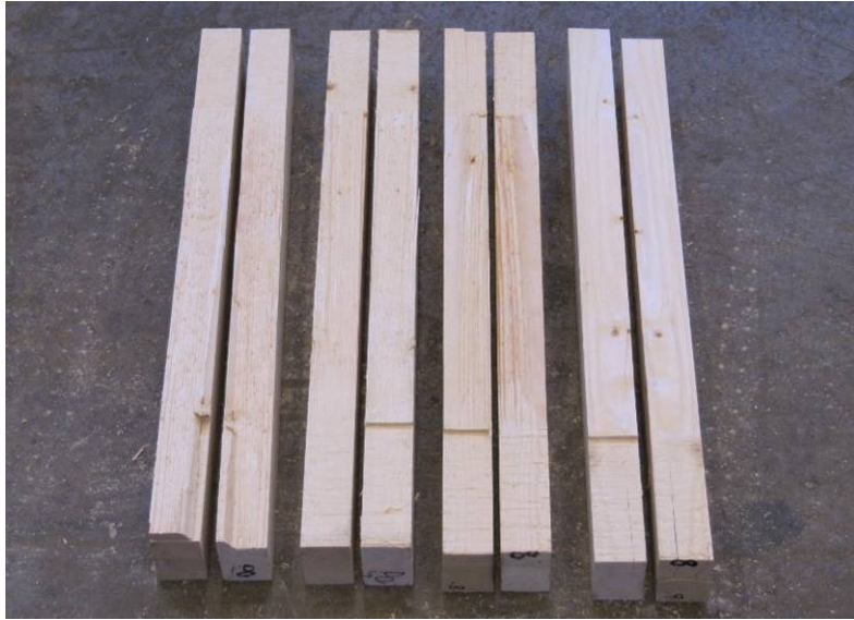
Provserie 8: rektangulärt tvärsnitt, b=40 mm
