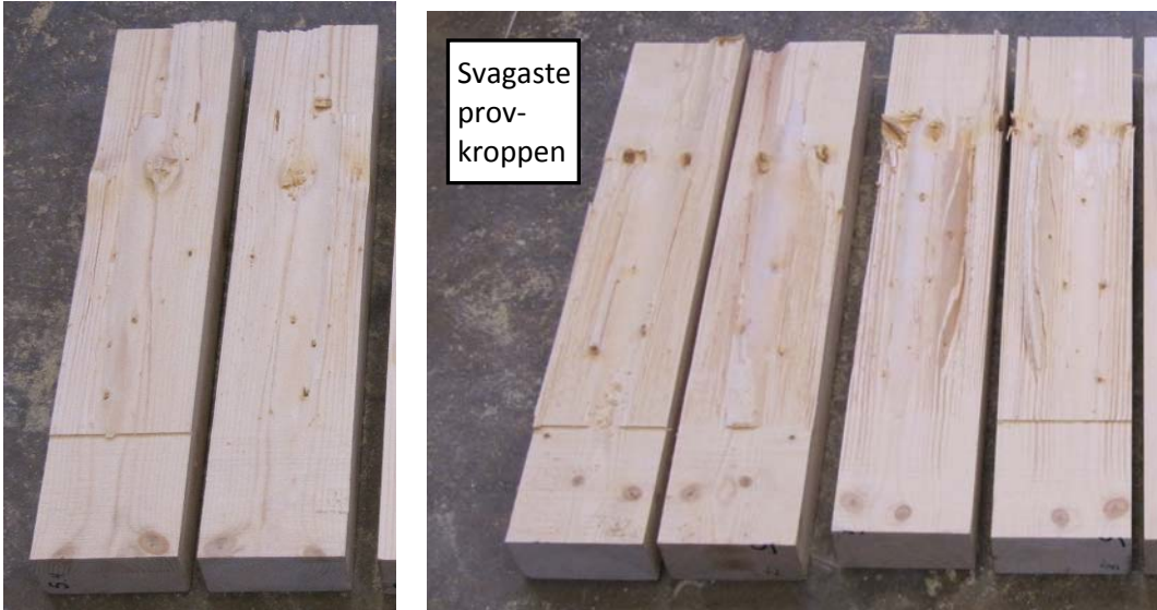
Provserie 2: rektangulärt tvärsnitt, b=115 mm
