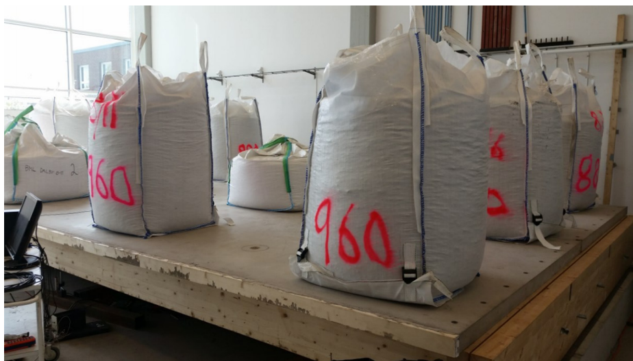
Belastning av bjälklagelement, med hjälp av grussäckar.
