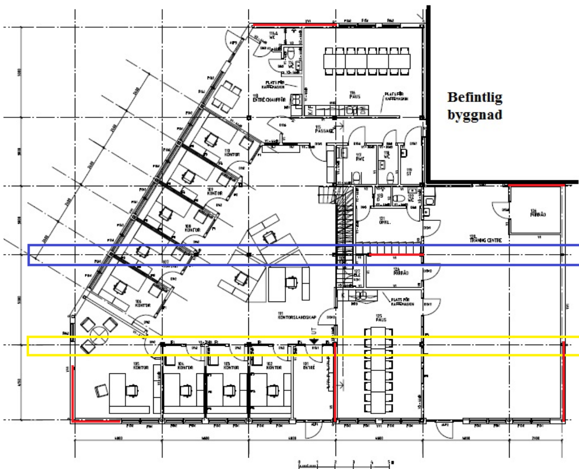
Figur 5.24 Redovisning av valda snitt, rött markerar vindstagen, blått för dimensionering av vindstag och gult för dimensionering av balkar och pelare.
