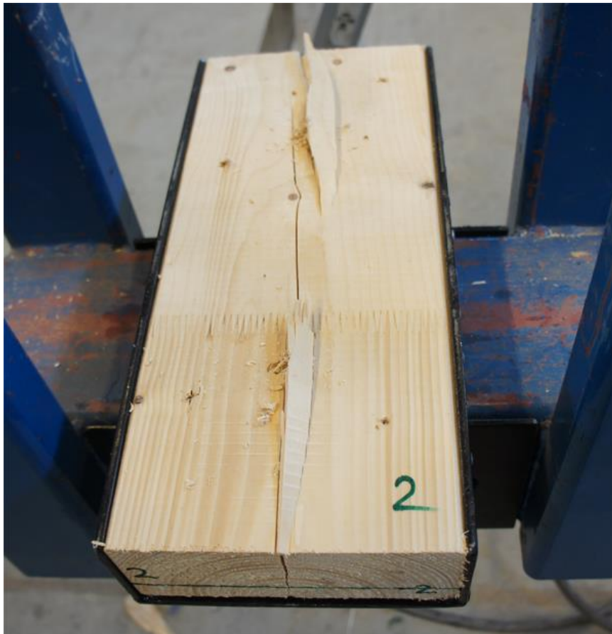
Figur 7.5: Sprucken regel från provkropp 02.
