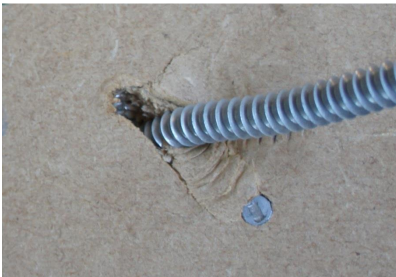
Figur 7.12: Deformationer i MDF-skiva på provkropp 06.
