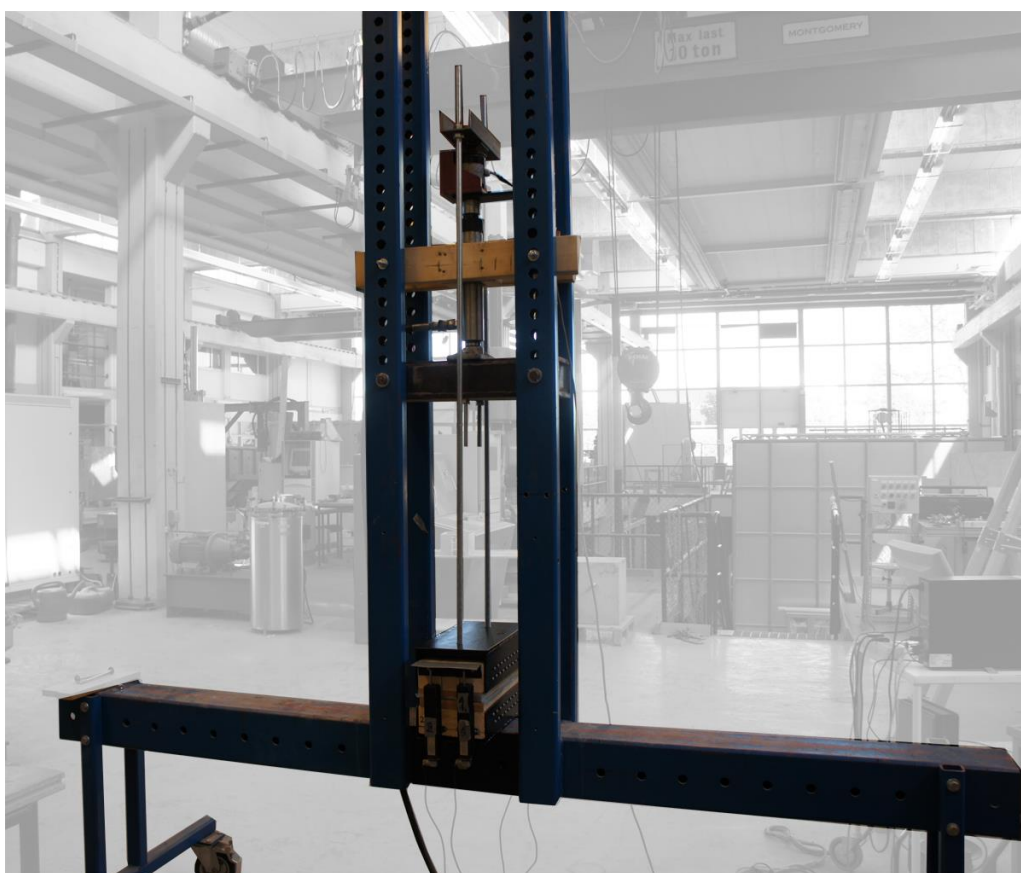
Figur 7.2: Provrigg för dragprov med monterad provkropp.
