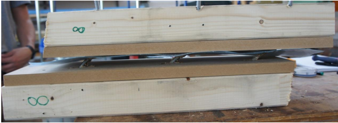
Figur 7.16: Skruvarnas deformationer efter provning i provkropp 08.
