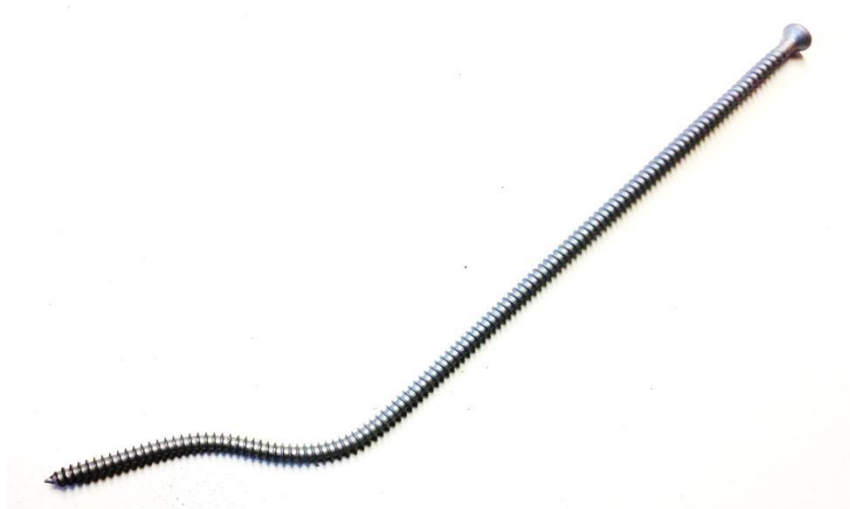
Figur 7.17: Uttagen skruv ur provkropp 08.
