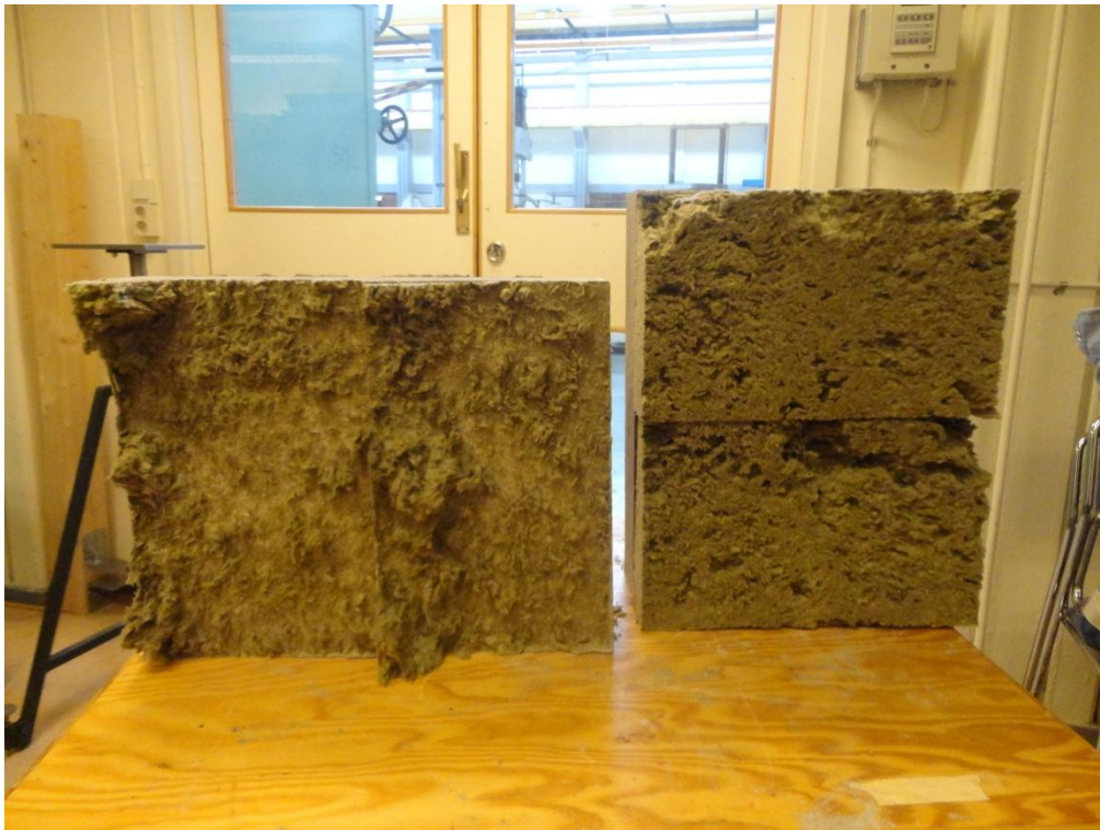
Figur 52. Provkropp som visar att vidhäftningen är begränsande.
