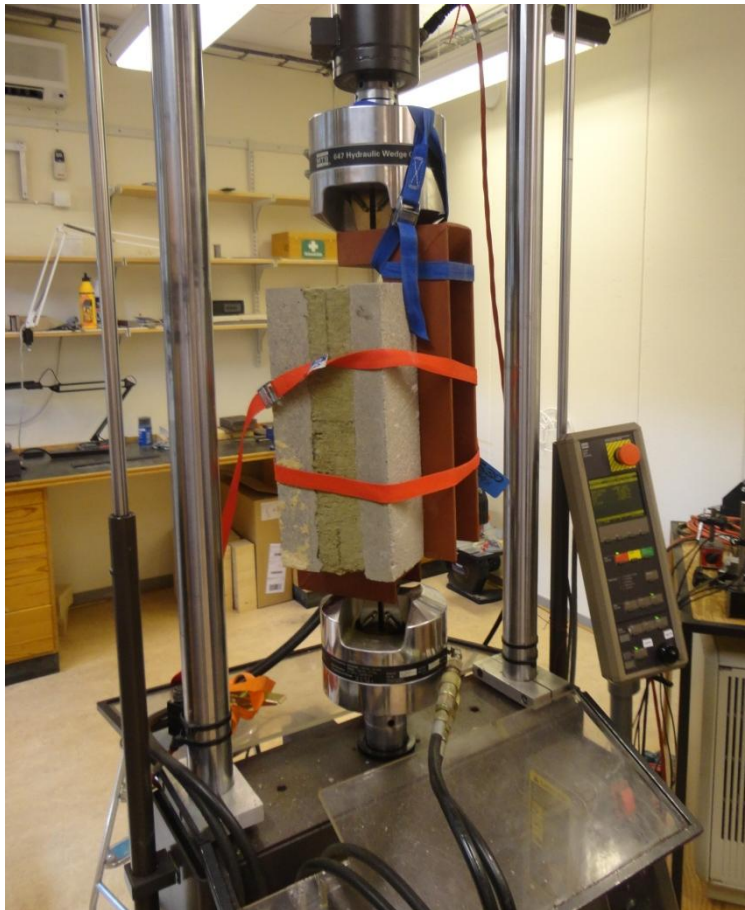
Figur 48. Spännband runt provkroppen och i ovankant maskinen.
