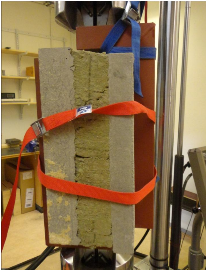
Figur 59. Brott i skjuvad provkropp.
