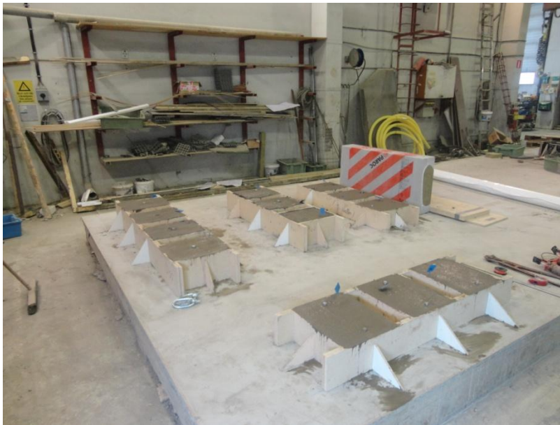
Figur 44. Provkropparnas yta jämnas till.
