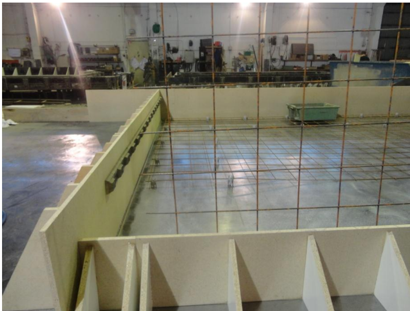
Figur 9. Inoljad gjutbädd med lister på plats.
