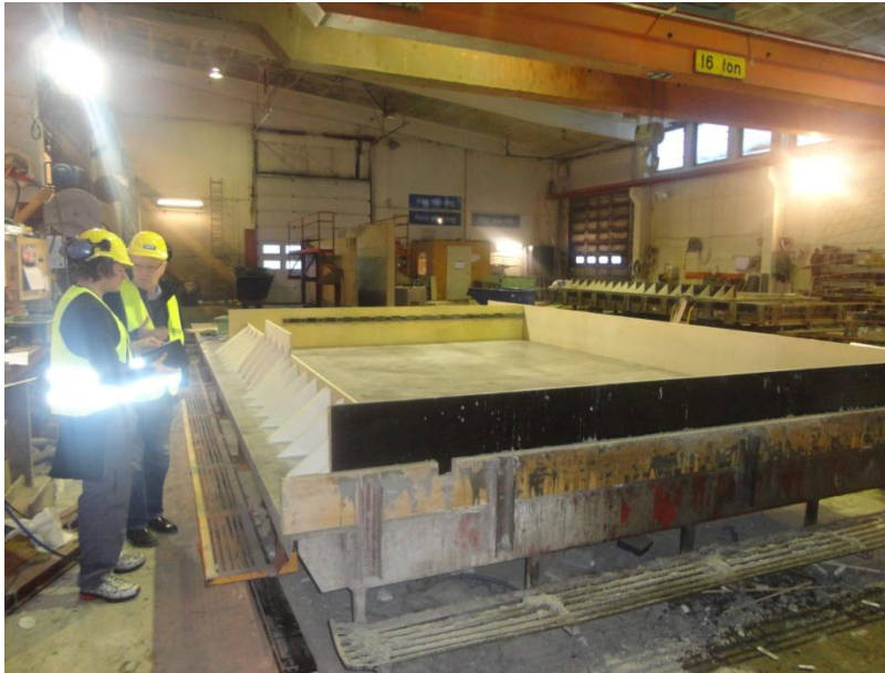
Figur 8. Formen placerad på gjutbädden.
