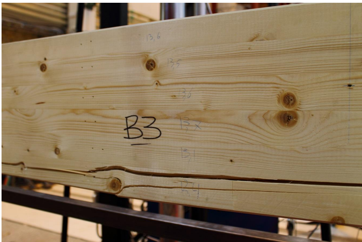
Figur 6.45- Balk B3, dragbrott vid kvist.
