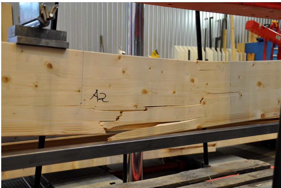
Figur 6.29 – Balk A2, drag och tryckbrott.
