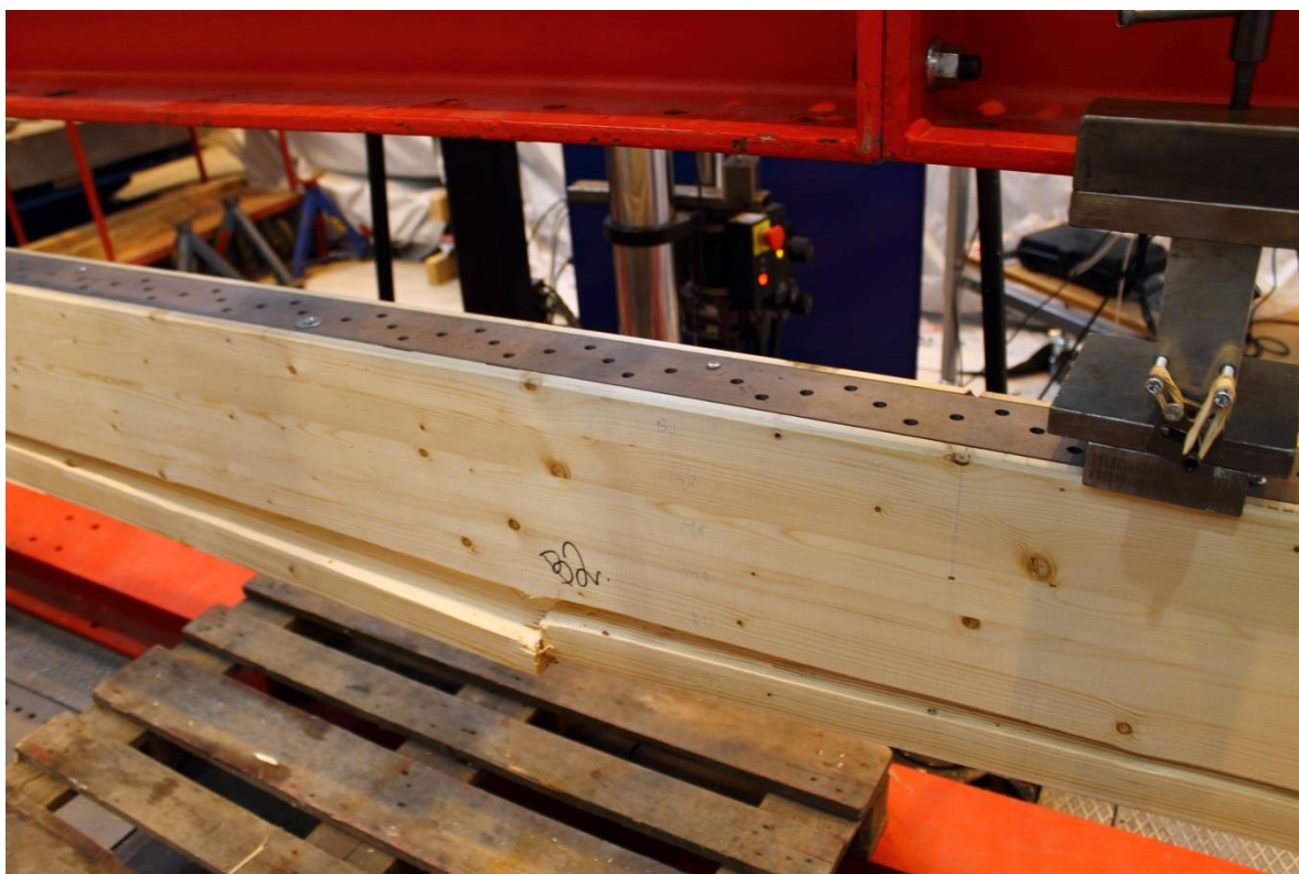
Figur 6.41. – Balk B2, dragbrott i fingerskarv.
