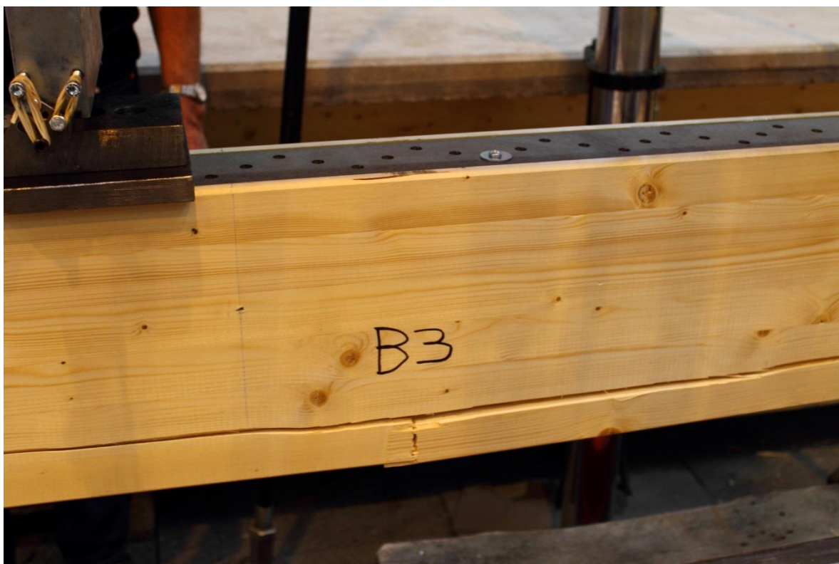
Figur 6.44 – Balk B3, dragbrott i fingerskarv.
