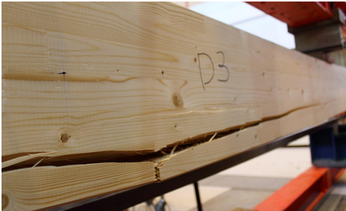
Figur 6.23- Balk D3, dragbrott runt fingerskarv
