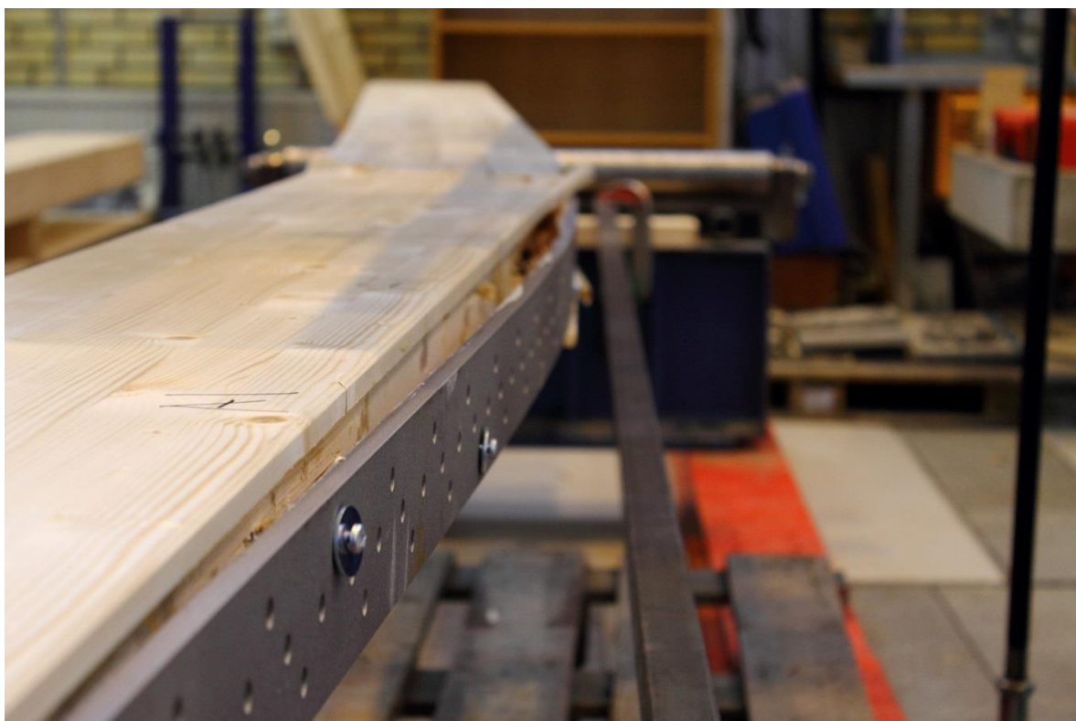
Figur 6.27- Balk A1, släppt stål.
