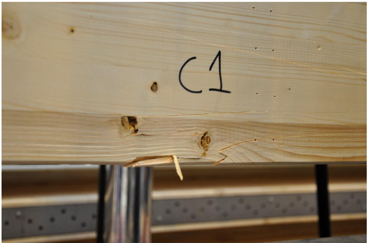
Figur 6.52- Balk C1, dragbrott vid kvist.
