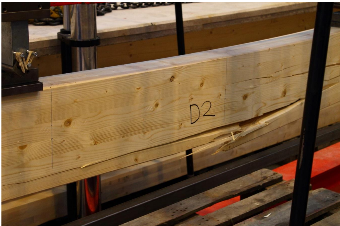
Figur 6.21 – Balk D2, dragbrott runt kvist.
