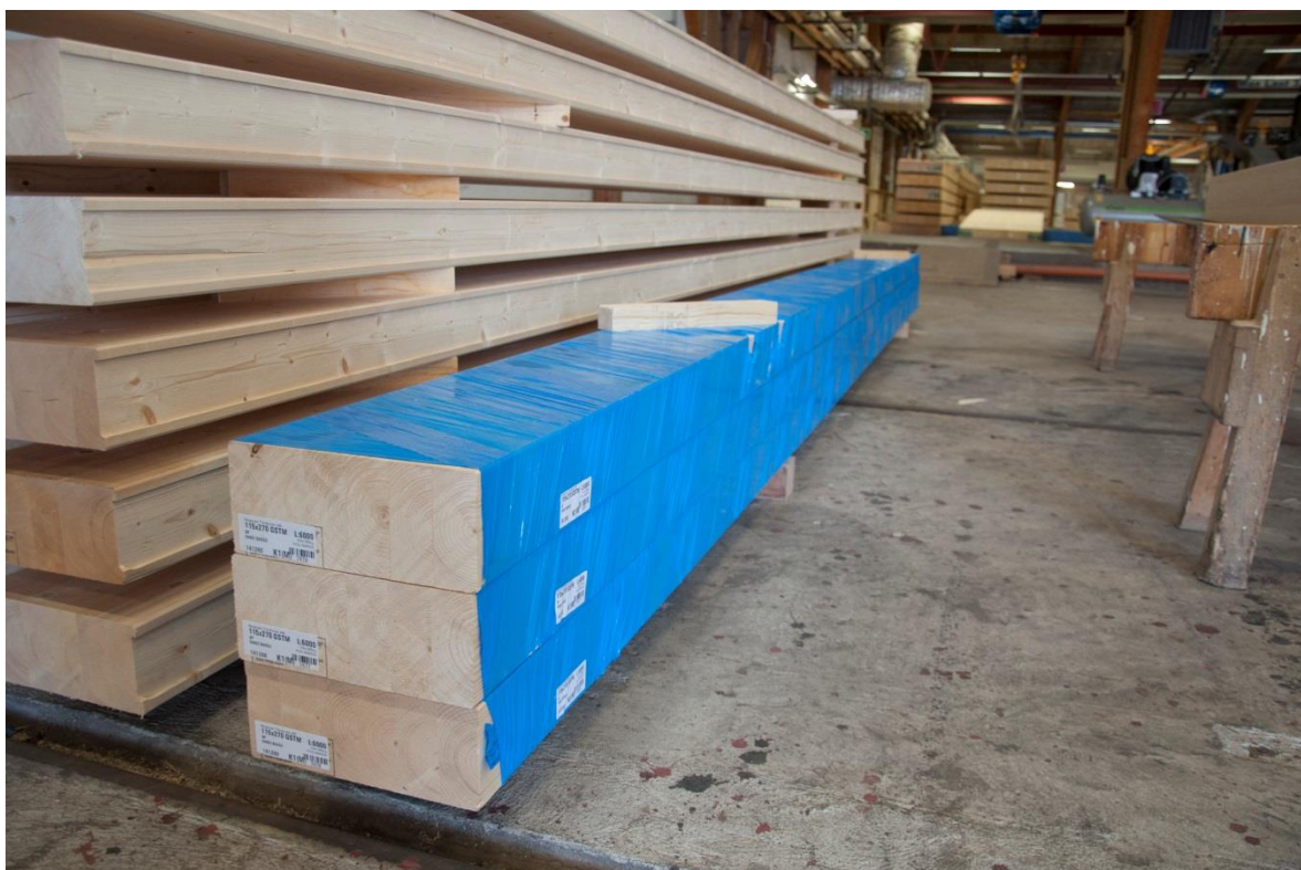
Figur 6.3 – Referensbalkar emballerade och klara för provning.
