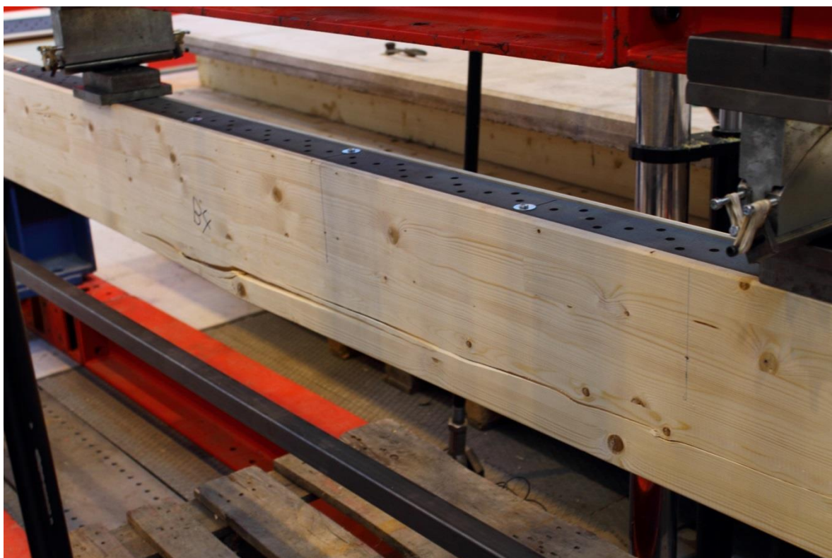
Figur 6.48- Balk B4, dragbrott runt kvist.
