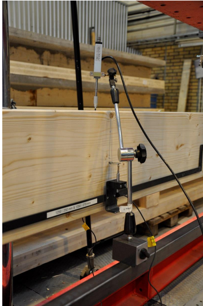
Figur 6.14- Givare för lokal och global nedböjning.
