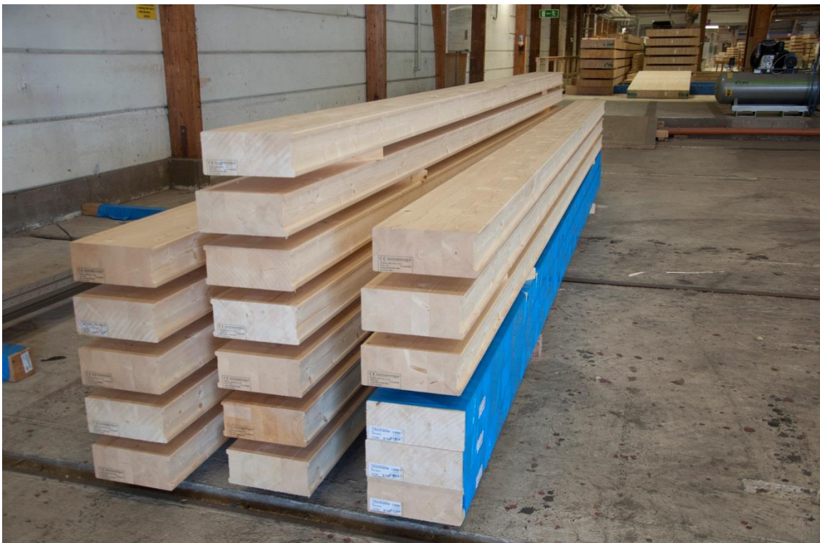
Figur 6.2 – 18 producerade limträbalkar från Moelven Töreboda AB.
