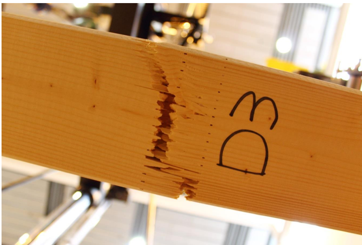
Figur 6.24 – Balk D3, underifrån, dragbrott runt fingerskarv.
