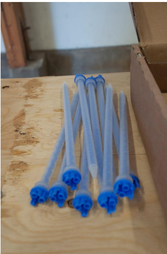
Figur 6.7 – Munstycken för blandning av lim och härdare.
