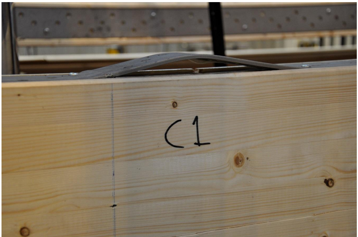
Figur 6.53- Balk C1, buckling av stål.
