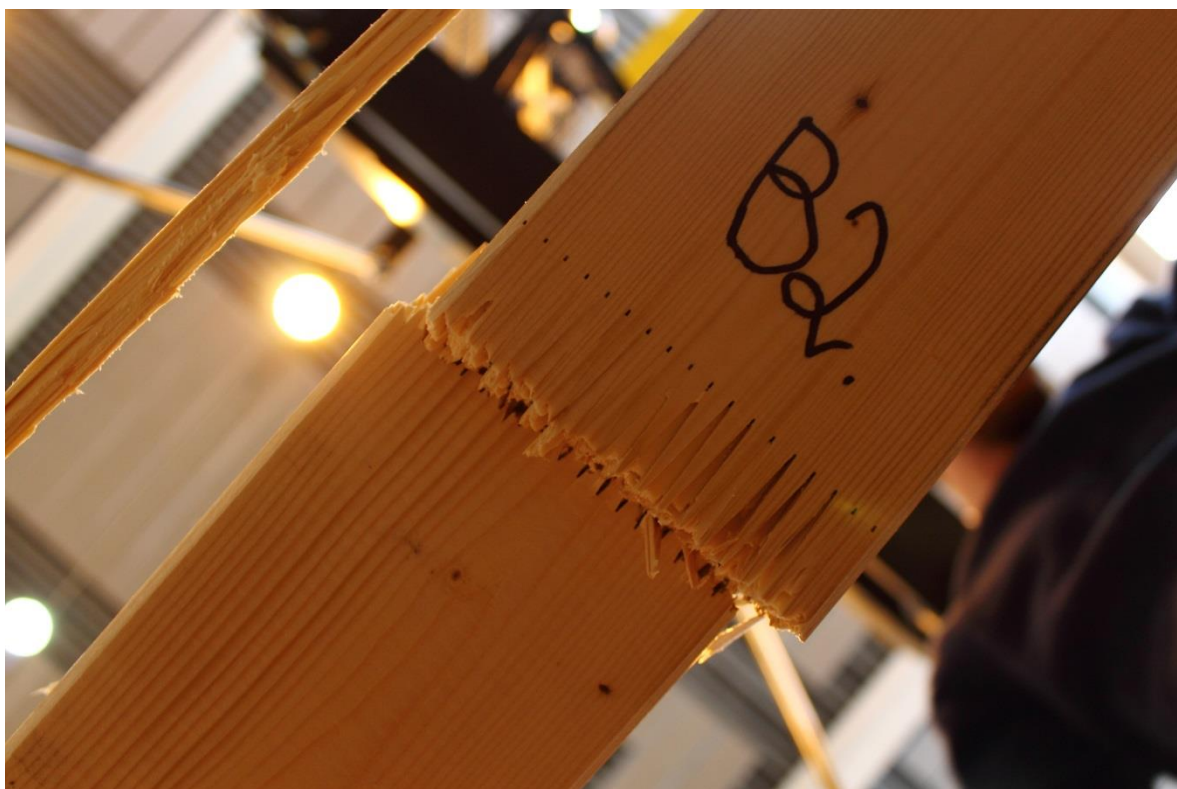
Figur 6.42 – Balk B2, underifrån, dragbrott i fingerskarv.
