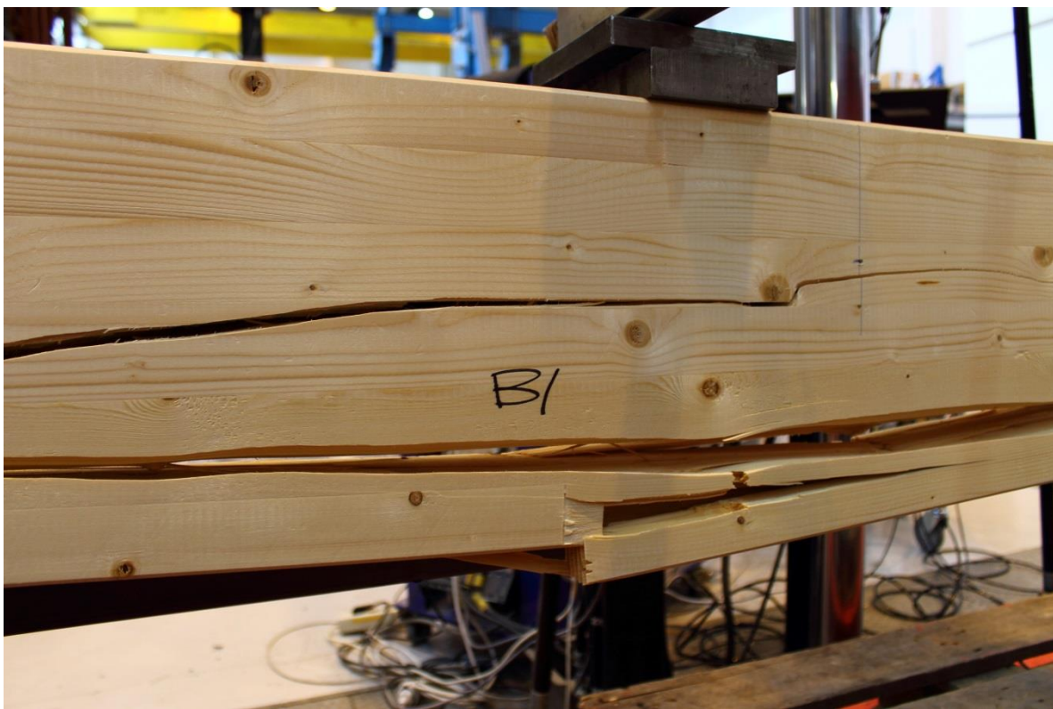
Figur 6.39 – Balk B1, lastinföringspunkt, dragbrott i fingerskarv
