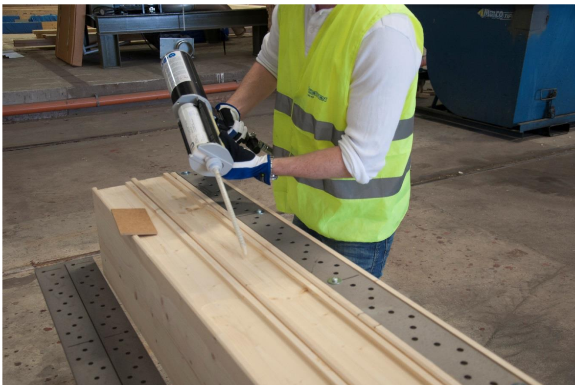
Figur 6.8 – Applicering av lim med limpistol.
