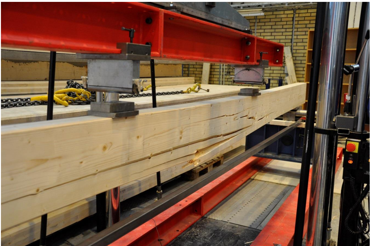
Figur 6.19 – Balk D1, dragbrott runt kvist.
