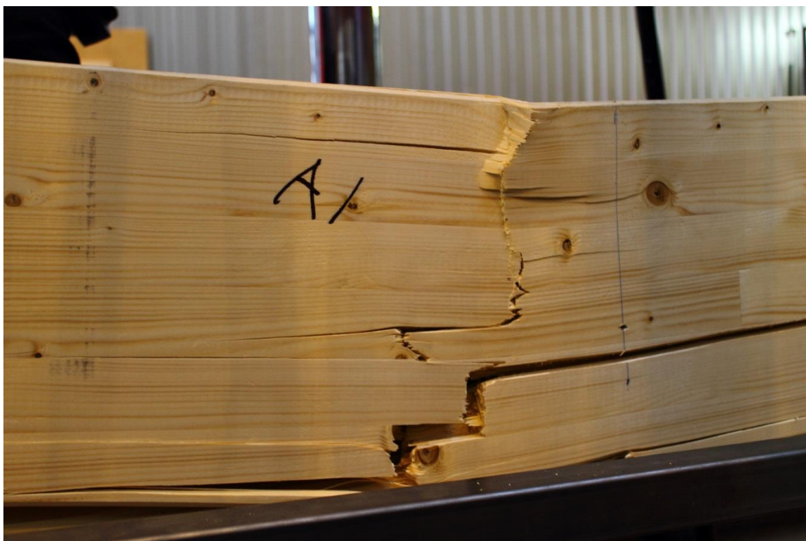
Figur 6.26- Balk A1, tryckbrott i träet.
