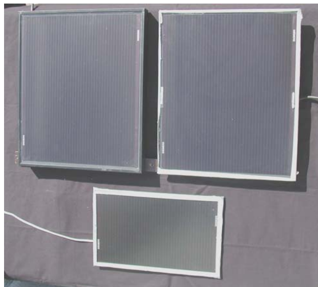
Figur 3.9 Tunnsolceller av CIGS. Solcell med beteckning L överst t v, solcell J, överst t h och nedan solcell K.
