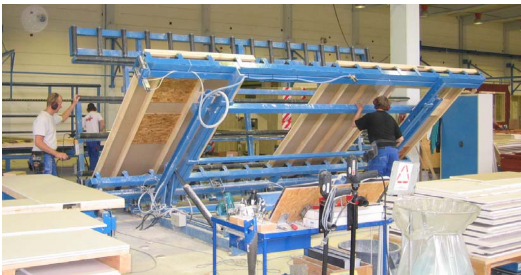
Bild 20. Vändning av väggelement.
