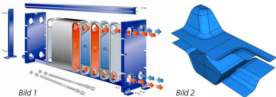
En plattvärmeväxlare består av ett antal tunna korrugerade plåtar med öppningar för de två vätskor mellan vilka värmeöverföringen sker. Plåtarna sätts samman med gummiträckningar (se Bild 1).
