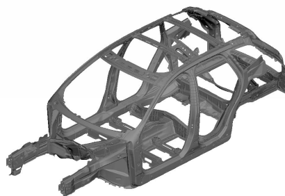
Figur 2: Balkstrukturen i karossen för en av de undersökta bilarna.
