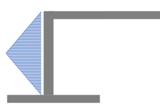
Triangulära jordtrycksfördelningen (blått) på rambenet.
