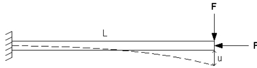
Figur 2.1: Fast inspänd balk belastad i den fria änden
