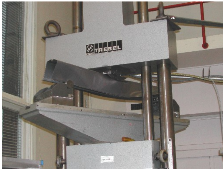
Figur 6.17: En av balkarna med ursprungligt tvärsnitt i nedtryckt läge i böjprovmaskinen
