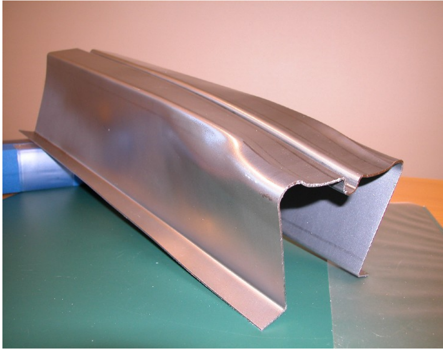
Figur 6.19: Den ursprungliga balken deformerad efter böjprov
