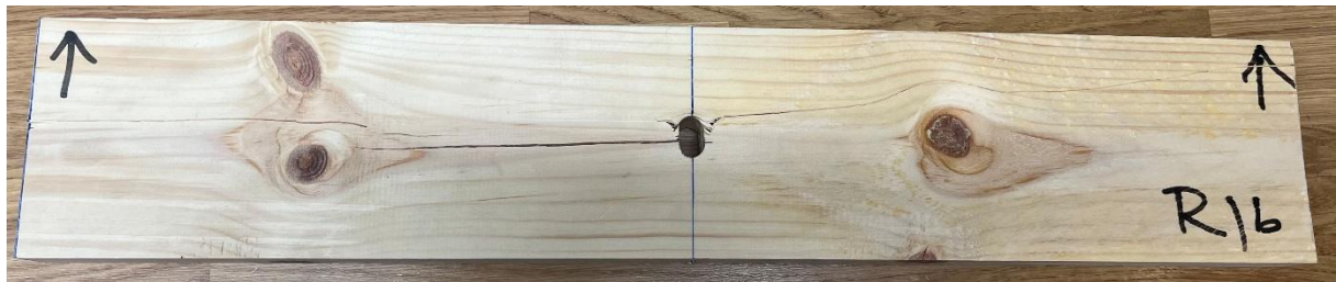
Figur 53 visar sprickbildningens initiering från hålets olika sidor
