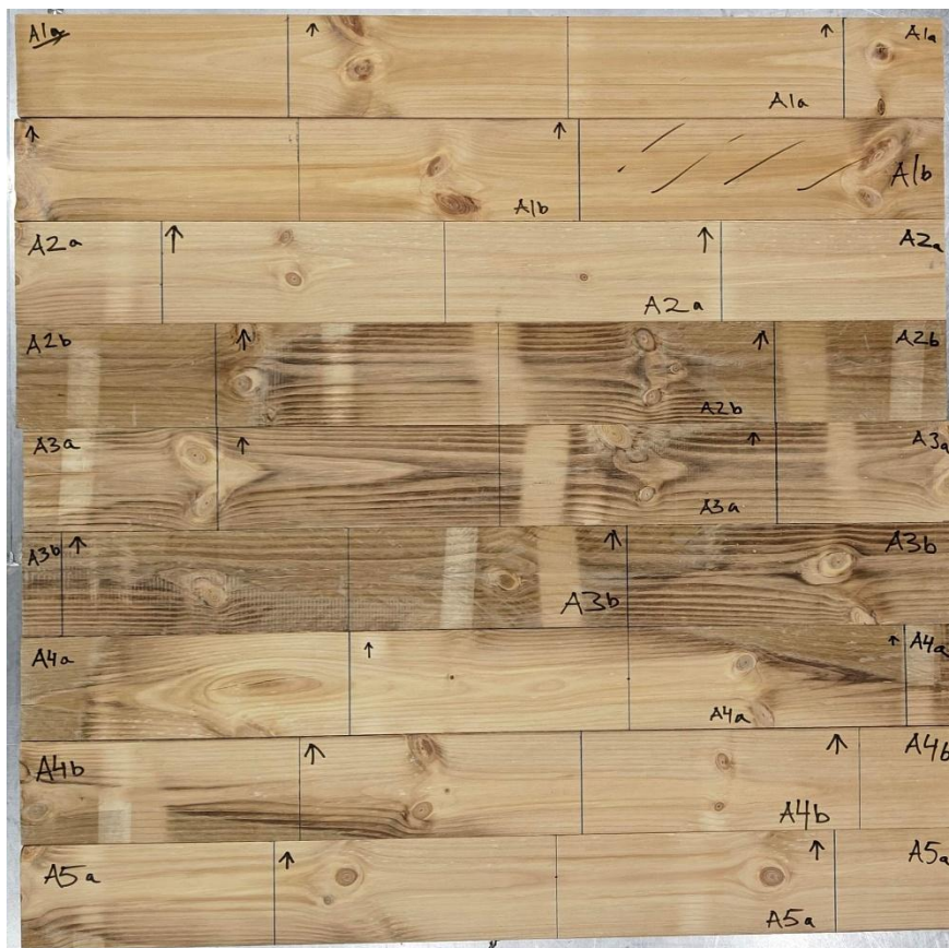
Figur A5. Provkropparna före sågning i förberedande momentet.
