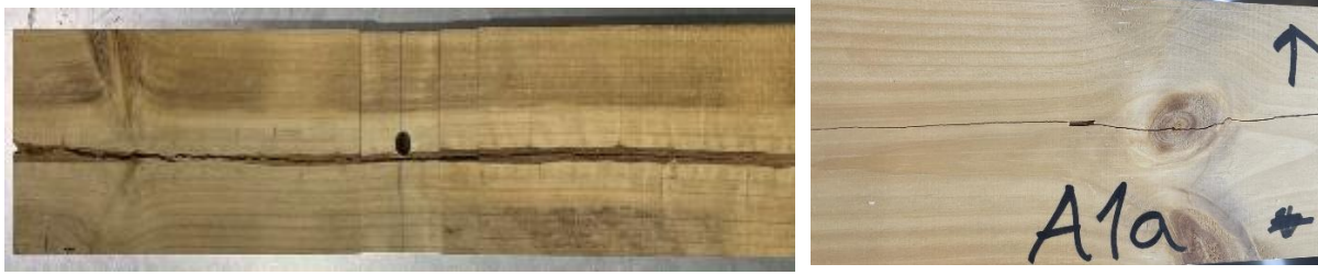
Figur 52 Visar sprickbildning genom kvisten för provkroppen A1a
