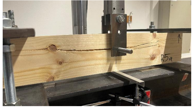
Figur A3. Provkropparna efter uppsprickning i provuppställningen
