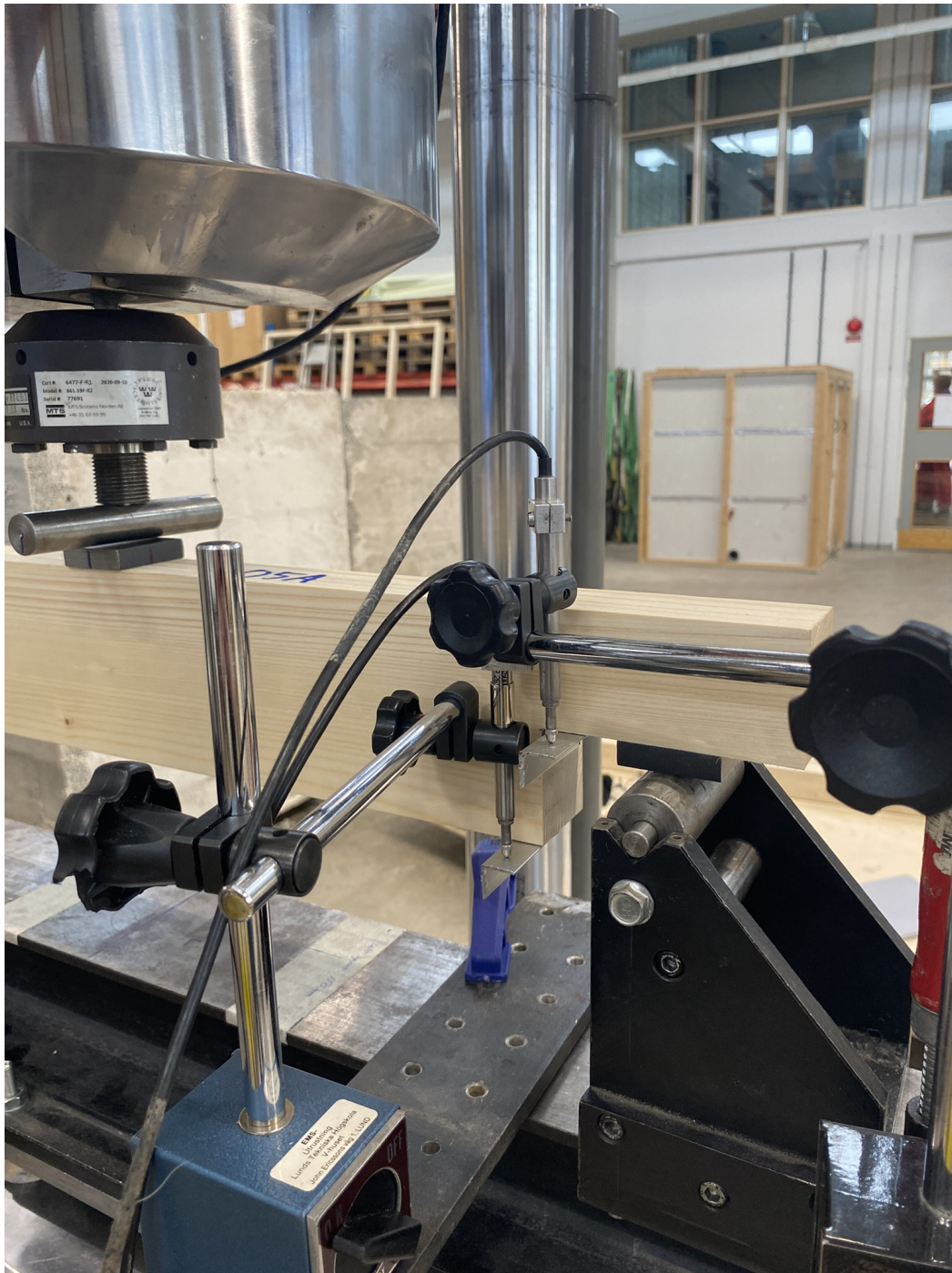
Figur 5.4: Bild på uppställningen av LVDT-mätare för en granbalk med höjden h = 100 mm.
