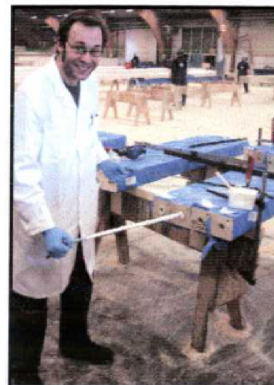
Figur 7. Applicering av lim, inlimmade stänger.
