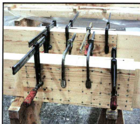
Figur 5. Presstryck m.h.a. tvingar.
