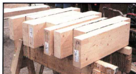
Figur 6. Förvaring av färdiga provkroppar (3c) på pallbockar.
